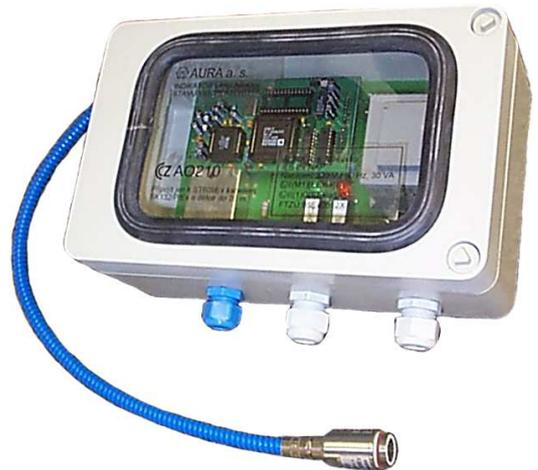
Сигнализатор помпажа вентилятора типа «ILS Ex» предназначен для обнаружения и индикации неустойчивого рабочего режима аксиального вентилятора. Прибор состоит из датчика динамического давления и блока оценивающей электроники. Оборудование одобрено для применения во взрывоопасной среде, с опасностью взрыва водорода и метана. Датчик может быть расположен в месте с опасностью взрыва метана и водорода, и так же в зоне 0. Электроника должна быть расположена во взрывобезопасной среде.
